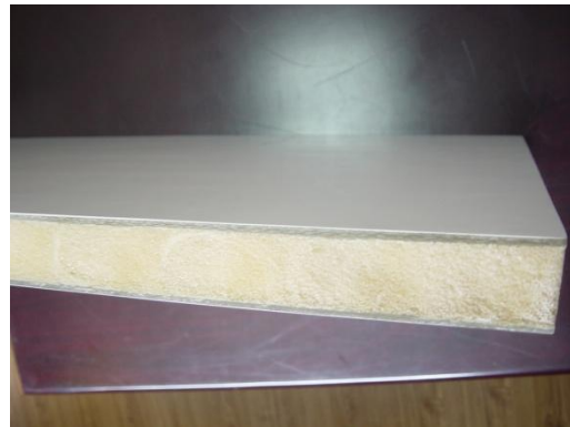
带彩胶面的特种玻璃钢上下面板
