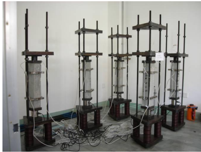
图 1 混凝土早期徐变测试系统
