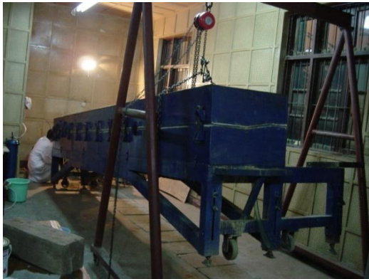
图 3、锁模、抽真空、注树脂、挤胶
