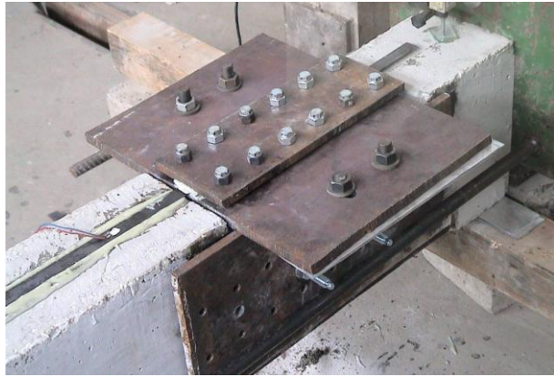
图1 预应力碳纤维塑料板锚固系统
