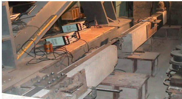
图2 锚固系统试验
