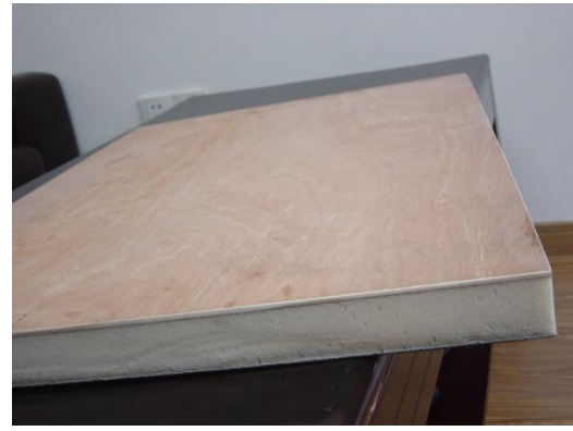
木三夹板上面板、特种玻璃钢下面板
