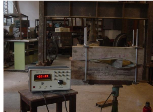
图 6、压力传感器记录静加载
