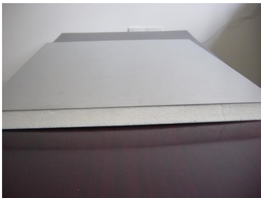
不锈钢上面板、特种玻璃钢下面板
