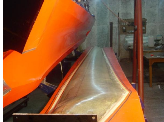
图 4、固化、退去智能芯、开模
