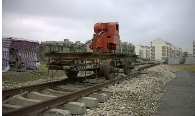
模拟列车动载下的累积变形试验
