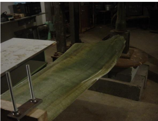
图 7、极限载荷下叶片局部失稳破坏
