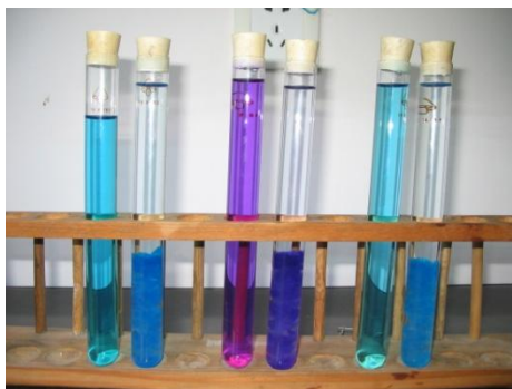
气凝胶对有机染料的吸附
