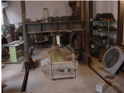
图 5、中空叶片结构试验准备
